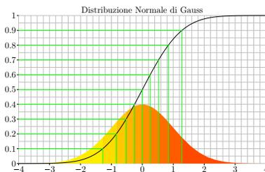
Figure 2.13: PDF e CDF di una variabile aleatoria Normale (di Gauss).
