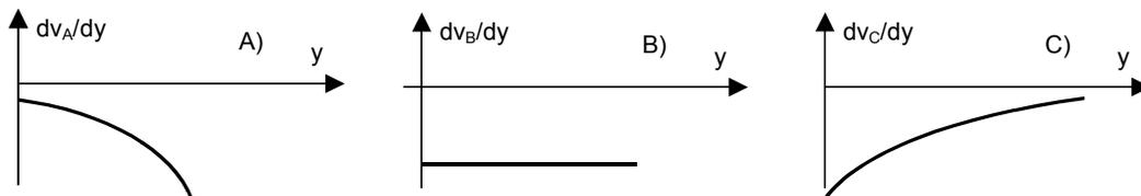
Fig. 4.7 Gradienti di velocità del fluido in tre sezioni del meato
